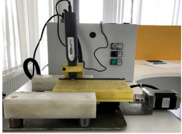
Şekil 1. Soğuk ABP işlemi için hazırlanan deney düzeneği (Experiment setup prepared for cold APP process)
