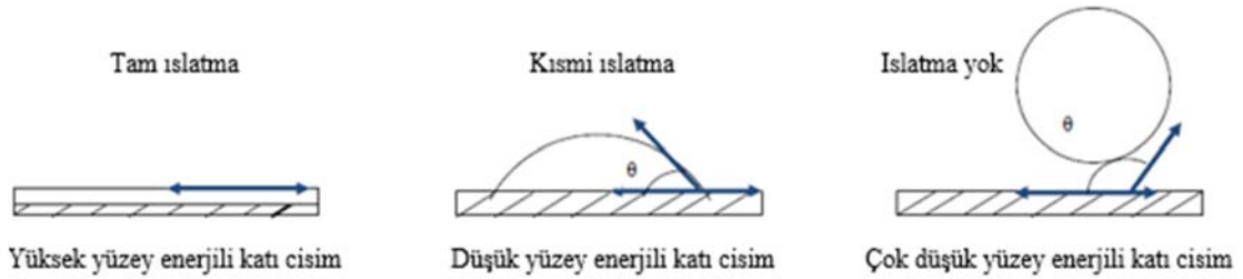
Şekil 5. Sıvıların farklı yüzey enerjisine sahip katı yüzeylerde ıslatma davranışları [42] (Wetting behavior of liquids on solid surfaces with different surface energies)
