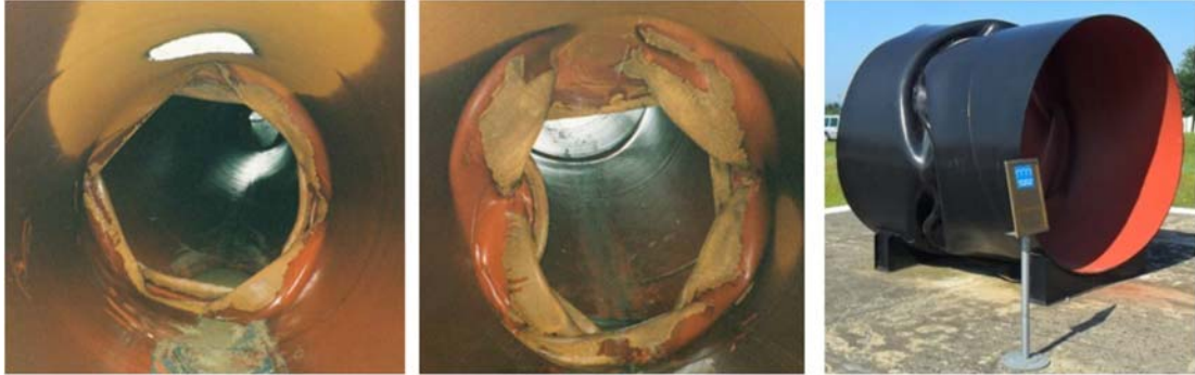
Şekil 7. Eksenel basınç yüklerine bağlı oluşan boru çapındaki azalma [11] (Reduction of pipe diameter due to axial compressive loads)
