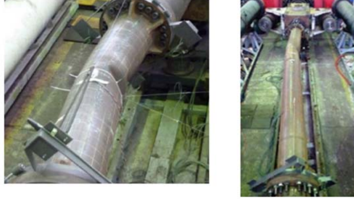
Şekil 1. Deneysel test altındaki kısa ve uzun boru numuneleri [13] (Short and long pipe samples under experimental test)
