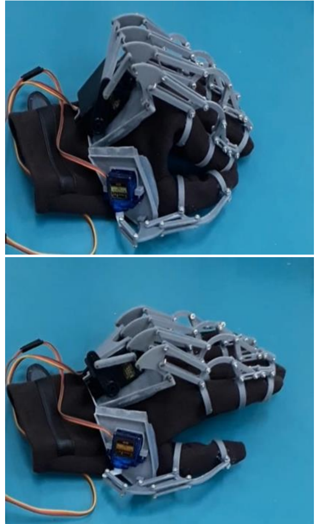
Şekil 19. Üretilen prototipin parmaklar tam kapalı ve tam açık görüntüleri
