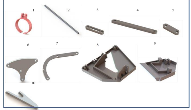
Şekil 4. Yapılan tasarımda kullanılan tüm elemanlar (1. Yüzük, 2. Pim, 3. Kanallı link bağlantısı, 4. Uzun link bağlantısı, 5. Kısa link bağlantısı, 6. Dört nokta bayrak elemanı, 7. Kuvvet aktarım elemanı, 8. Motor montaj bloğu1, 9. Motor montaj bloğu2, 10. Destek elemanı, 11. M2 cıvata ve somunu)
