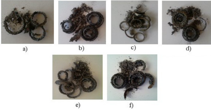
Şekil 9. Masif telle V-alın parçaların 14 paso ile kaynağında torcun her iki nozulunda biriken toplam çapak.
