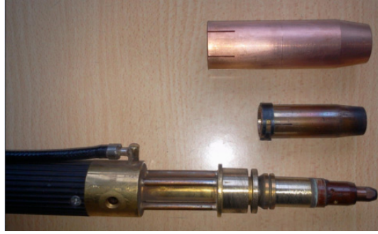
Şekil 3. Çift kanallı gazaltı kaynak torcu
