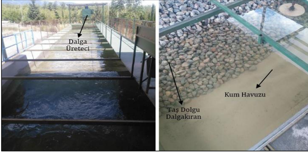
Şekil 1. Deneysel olarak kullanılan dalga kanalı ve taş dolgu dalgakıranının genel görünümü.
