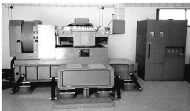
Figure 2-Electro-hydraulic shaker used in experiment Şekil 2-Denemede kullanılan elektrohidrolik sarsıcı
