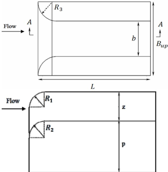
**Figure 2-Definition sketch of models used in theoretical analysis: (up) plan view; (down) longitudinal profile A-A***Şekil 2-Teorik analizde kullanılan modellerin taslak açıklaması: (üstte) plan görünümü, (altta) A-A boyuna kesit*
