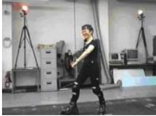
Şekil 4. Maker Tabanlı Tam Vücut MoCap
