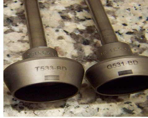
Şekil 3. Deneysel çalışmada kullanılan Belcoro rotorların görüntüsü
