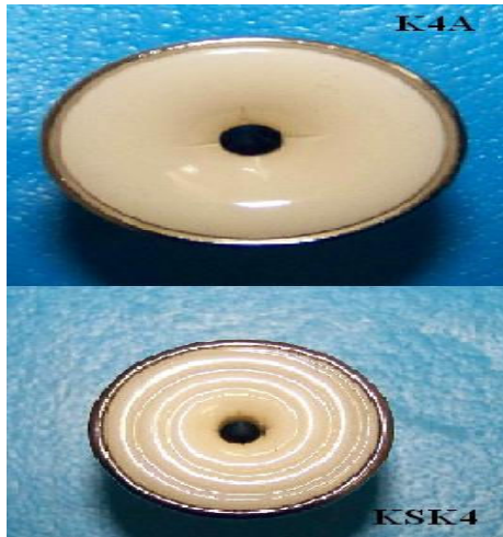
Şekil 2. Deneysel çalışmada kullanılan KSK4 (spiral ve 4 çentikli) ve K4A (düz ve 4 çentikli) iplik çekim navelleri.
