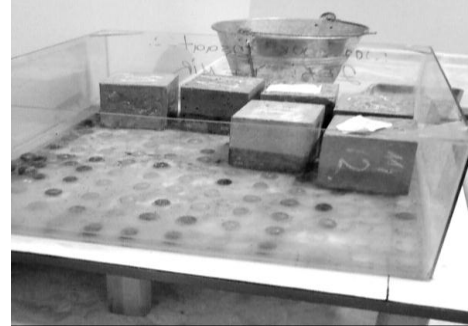
Şekil 3. Kapiler Su Emme Deneyi
