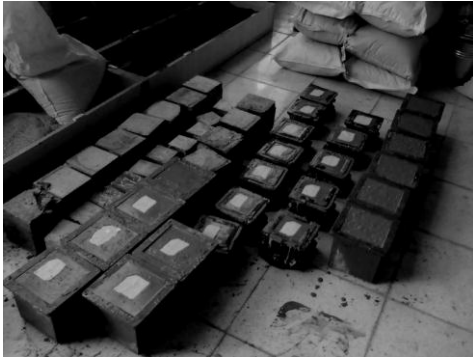
Şekil 1. Deneylerde kullanılan beton numuneler
