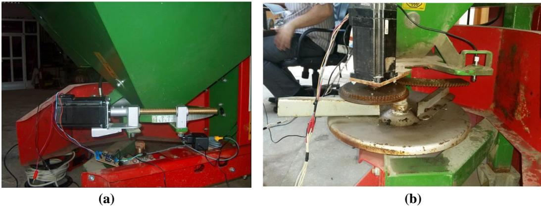
**Figure 2.** Old design (toothed axle) (a) and new design (with gears) (b) plate control system**Şekil 2.** Eski (dişli mil) ve yeni (dişli) değişken oranlı gübre akış kapak kontrol mekanizası
