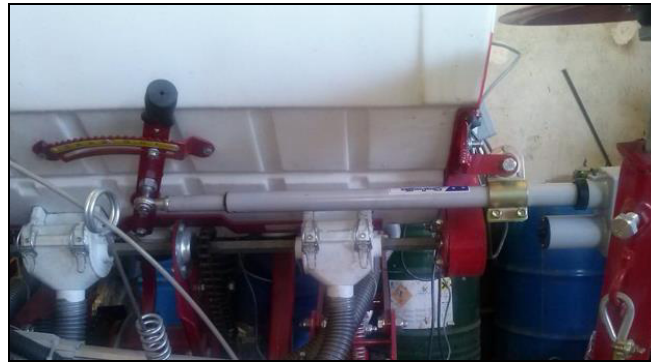
Figure 1. Flow rate control mechanism Şekil 1. Gübre akışı kontrol mekanizması
