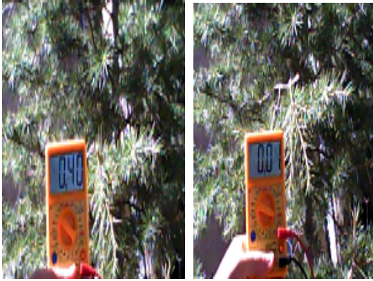
Şekil 9. Gövdesindeki deliklere NaOH enjekte edilen çam ağacından elde edilen volt ve amper değerleri
