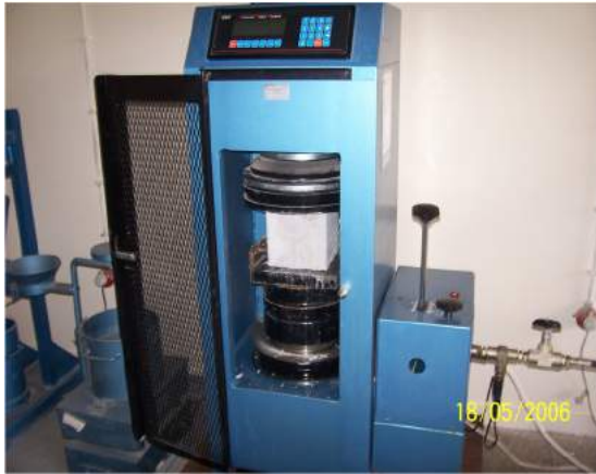
Şekil 16. Hazırlanan beton örneklerinin dayanım deneyleri
