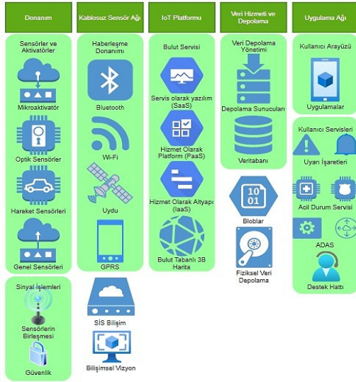
Şekil 3. Akıllı araç genel IoT yapısı
