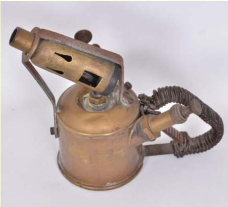
Şekil 9: Kuron-köprü protezlerinde lehim yapmak için kullanılmış petrol lambası
