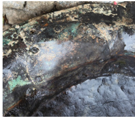
Fotoğraf 28-29: Küçük kazanı alev yüzü ayrıntıları (sağdaki fotoğrafta yama görülüyor).
