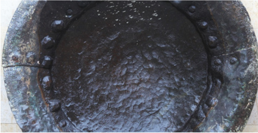
Fotoğraf 27: Küçük kazanı alev yüzü ayrıntısı.
