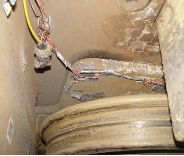
Şekil 13 İç şasi üzerine yapıştırılan gerinim-ölçerlerin üstten görünüşü.
