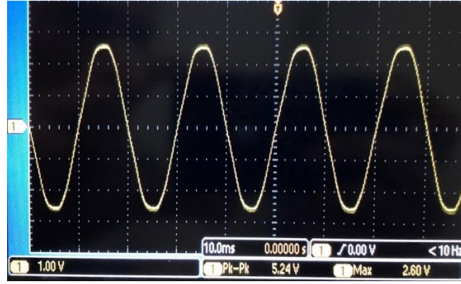
Şekil 9. R-SFCL’li sistemdeki arıza akımının osiloskop görüntüsü
