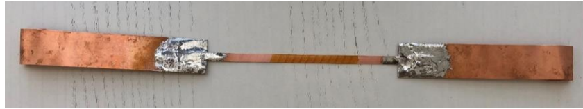
Şekil 4. Bakır plaka ile süperiletken şerit bağlantısı
