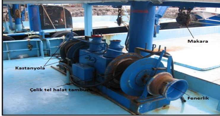
Şekil 5. Tekne üzerine monte edilmiş trol ırgatı (Orijinal)
