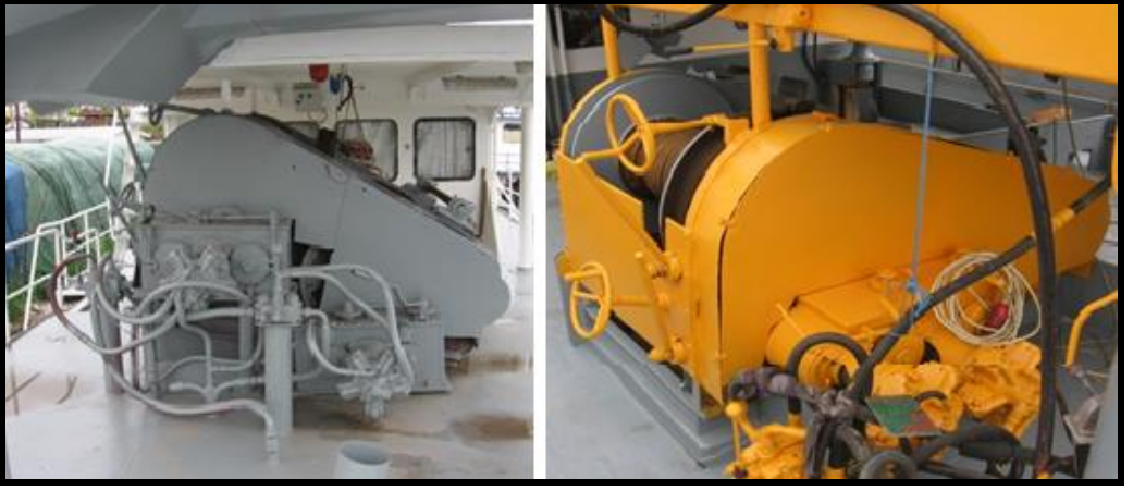
Şekil 6. Orta ölçekli hidrolik gırgır ırgatı (Orjinal)
