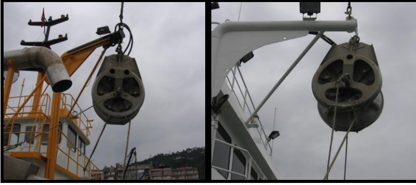
Şekil 2. Sancak tarafa monte edilmiş power block sistem (Orjinal)
