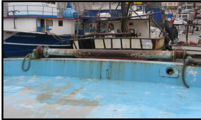
Şekil 4. Tekne kış üstüne monte edilmiş trol tamburu (Orjinal)
