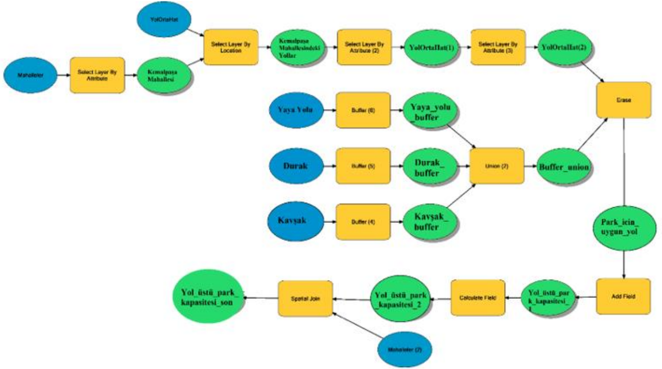
Şekil 11. Model Builder ile yol üstü park kapasitelerini hesaplatan model (Bir mahalle için oluşturulmuş model örneği)
