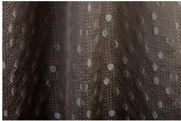
Şekil 3. Naylon, yün ve polyester ile dokunmuş rölyef kumaş ( www.nuno.com )
