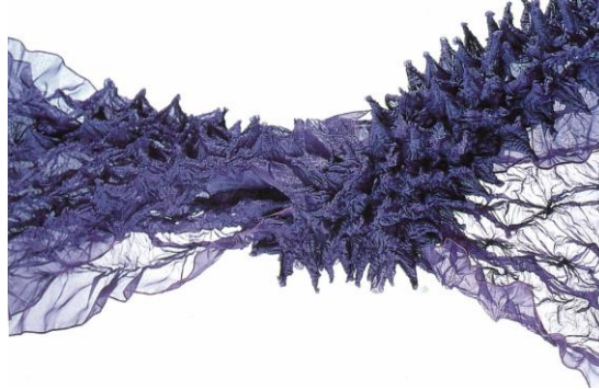
Şekil 12. Termoplastik iplikle dokunmuş, bitim işlemi görmüş kumaş (Braddock&Q'Mahony, 1999,s.79)
