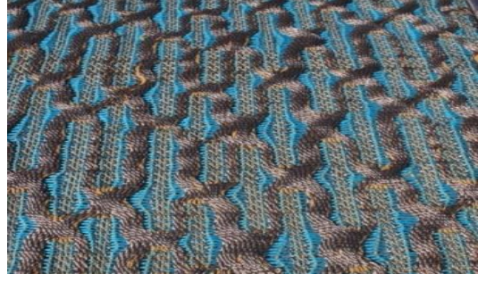
Şekil 8. Çift katlı jakar tekniği ile dokunmuş kumaş ( http://www.denamolnar.com )
