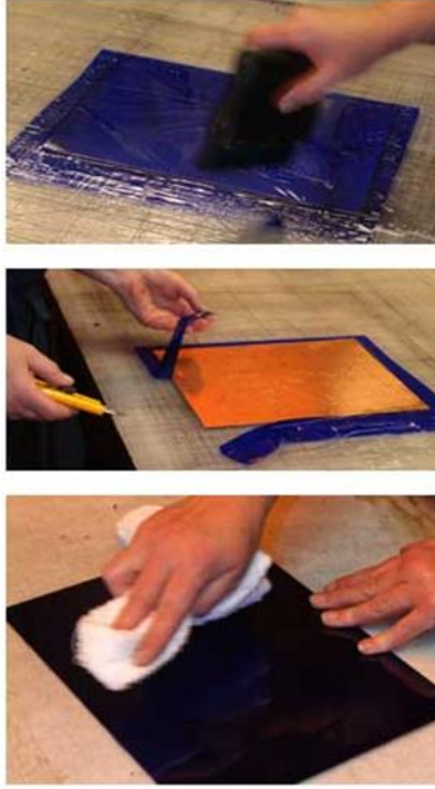
Şekil 6. Plaka ve filmi Mylar yukarı bakacak şekilde çalışma yüzeyine yerleştirilir. Mylara bol su püskürterek sürtünme azaltılır.
