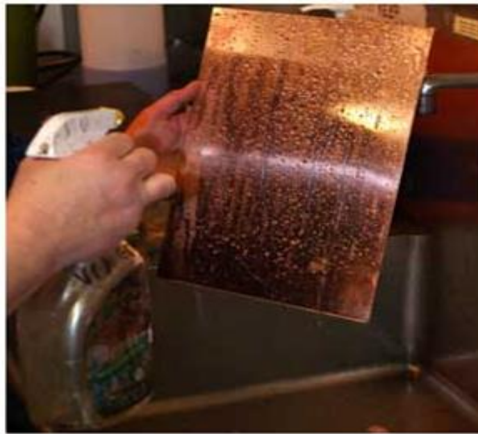
Şekil 1. Yüzeyde bulunabilecek yağların temizlenmesi.
