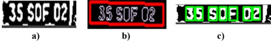
Şekil 4. a) Kenar belirleme işlemi, b) plaka metninin bulunduğu bölge c) plakada tespit edilen karakterler
