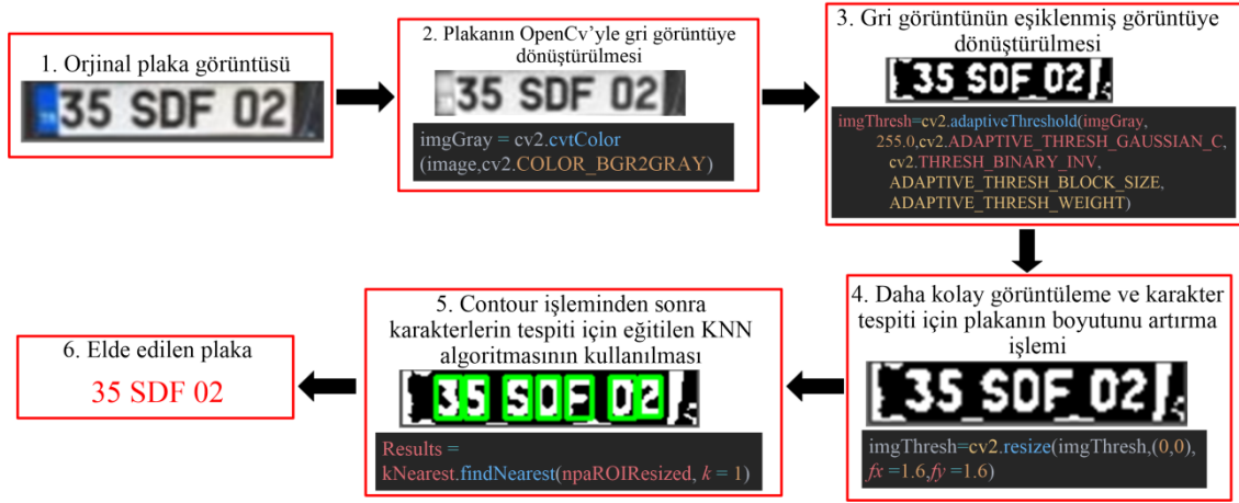
Şekil 6. Plaka analizinin işlem basamakları
