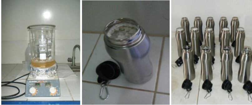
Şekil 3. Isı depoları ve kimyasalın ergitilmesi
