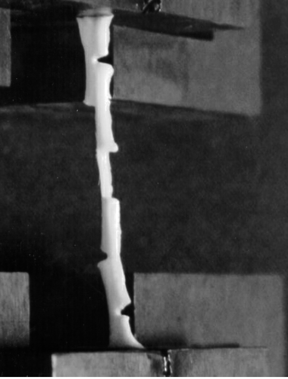
Şekil 4: Gerilim testinde kopmadan hemen önceki görünüm
