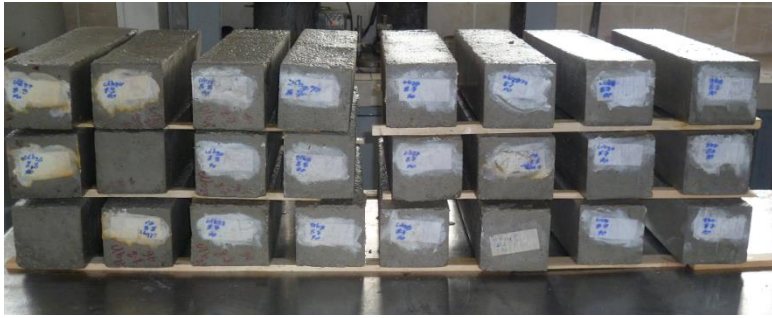
Şekil 1. Karbonatlaşmaya Bekletilen Betonlar (Concrete carbonation held)
