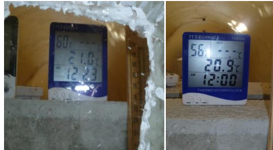
Şekil 3. Tankın İçinde Nem Miktarı Ölçümü (Measurement of Moisture Content in the tank)
