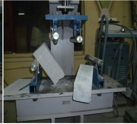
Şekil 12 Çelik lifsiz betonun kırılması (Steel lint fracture of concrete)
