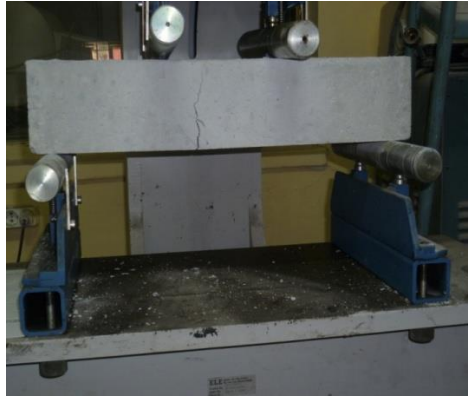
Şekil 11. Çelik lifli betonun kırılması (Fracture of steel fiber concrete)
