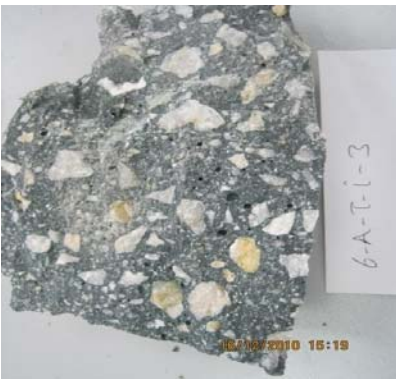
Şekil 9. 180 gün sülfatlı ortamda bekletilen YFÇ çimentolu beton numunelerinde kabuk kısmın çekirdek kısmından ayrılarak oluşan kırılma ve numune içinde oluşan boşluklar.
