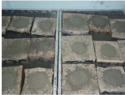
Şekil 4. Zemin örnekleri içerisinde açılan deliklere hazırlanan betonun dökülmesi.
