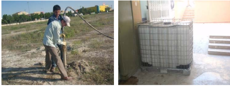
Şekil 3. Arazide sondaj kuyusundan sülfatlı suyun çekilmesi ve laboratuara taşınması.
