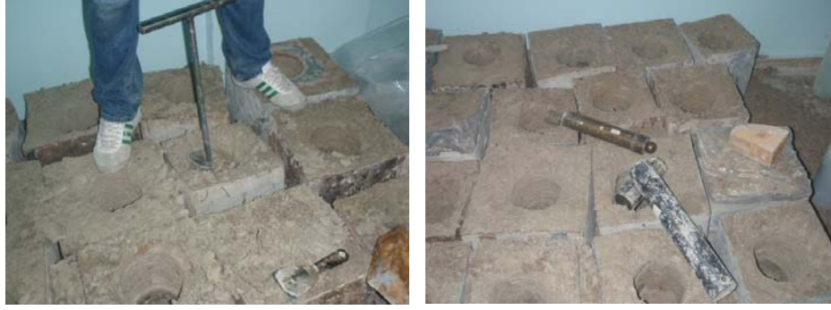
Şekil 2. Kalıp içerisindeki zeminin örneklerine standart silindir beton numuneler için delik açılması.
