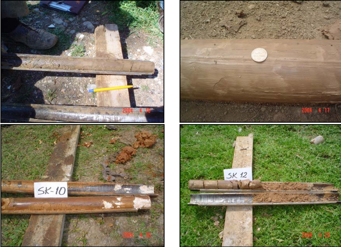
Şekil 3. Sondaj çalışmalarında farklı noktalardan elde edilen killerin görüntüsü.
