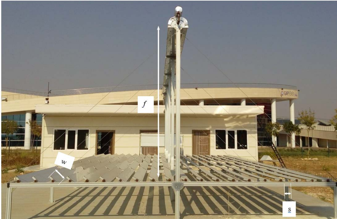
Şekil 1. İncelenen doğrusal Fresnel kolektör (Linear Fresnel collector studied)
