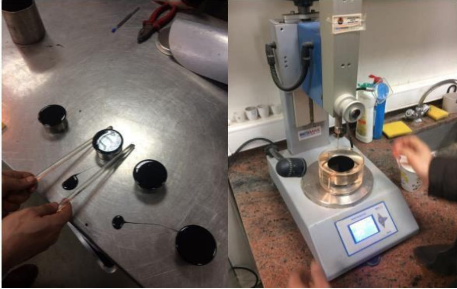
Şekil 3.1 Penetrasyon deney numunesi hazırlanması ve penetrasyon deney cihazı
