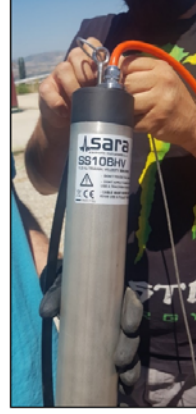
Şekil 5. Mikrosismik gözlem istasyonlarında kullanılan kuyu tipi algılayıcı (sol panel) ve sayısallaştırıcı (sağ panel). (Borehole seismic sensor (left side) and digitizer (right side) used in microseismic monitoring )
