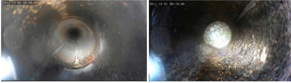
Şekil 6. Kuyu içi durumunu belirlemek amacıyla yapılan kamera çekimlerine ait görüntüler. Kuyu ortası (sol panel) ve kuyu tabanına (sağ panel) ait örnekler.
