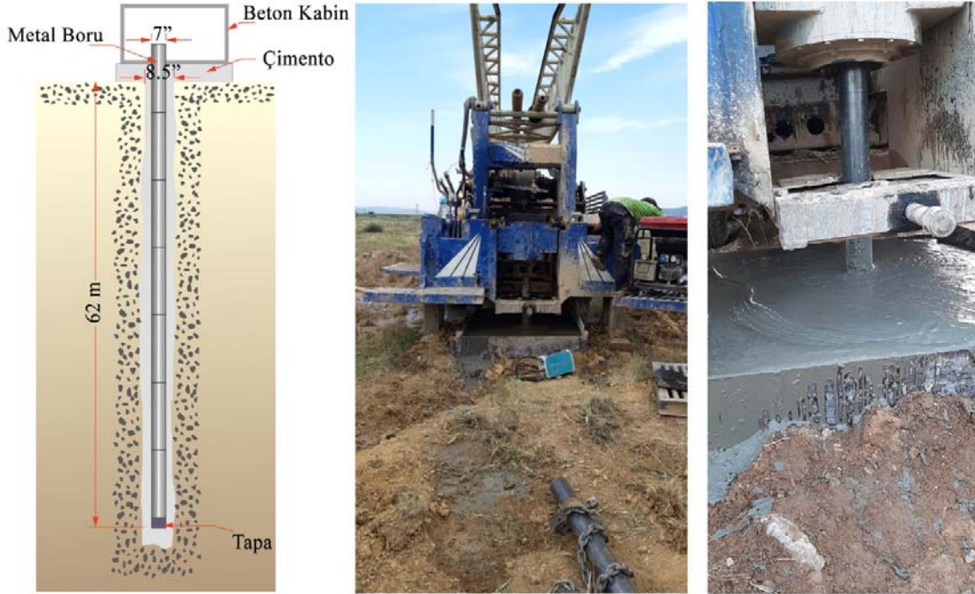
Şekil 3. Mikrosismik gözlem istasyon kuyusunun şematik gösterimi (sol panel) ve kuyularının hazırlanması (orta ve sağ panel). (Schematic visualization of microseismic observation station well (left side) and preparing the wells (middle and right side))
