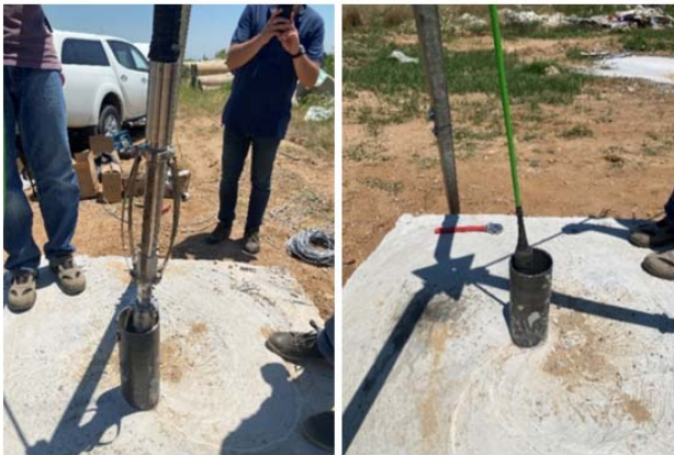
Şekil 7. Kuyu eğimini belirlemek amacıyla yapılan tiltmetre ölçümlerinden görüntüler. (Images of tiltmeter measurements to determine the slope of the well.)
