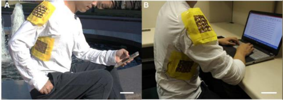
Şekil 5. Dış (A) ve iç mekan (B) koşullarında çalışan kendi kendini şarj eden elektrikli tekstil tasarımı [17]
