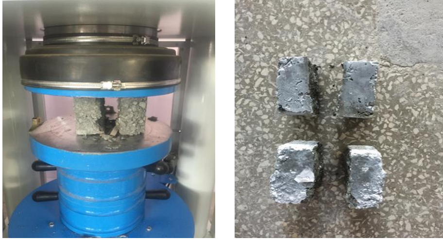
Şekil 3. Düzlem boyunca kırılan numuneler
