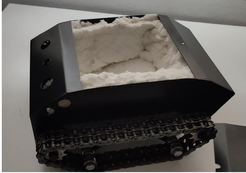
Şekil 10. Yalıtım işleminin ardından şasinin görünümü (View of the chassis after isolation process)
