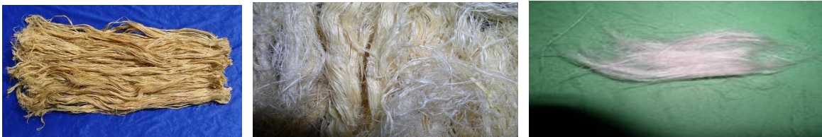
Şekil 6. İşlenmemiş, ince ve tekstilde kullanılan doğal bambu lifleri
