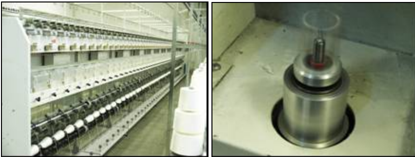
Şekil 1. Biemme makinesi ve iplik oluşumunun gerçekleştiği örücü kafa
