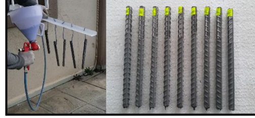
Şekil 1. Püskürtme yöntemi ile donatılara bulamaç uygulaması.
