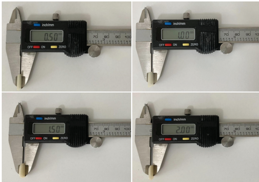
Resim 1. Test örneklerinin kalınlıklarının ölçümleri
