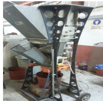
Resim 4- Sorgumun peletlendiği makine
