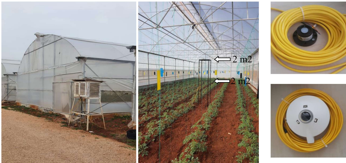
Şekil 2. Piranometre, Quantum algılayıcıları ile sıcaklık-nem sensörlerinin sera içi ve dışındaki konumları Figure 2. Positions of pyranometer, quantum sensors and temperature-humidity sensors inside and outside the greenhouse
