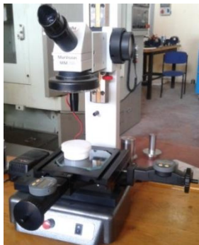
Şekil 2. İş parçasında oluşan çapaklanmanın ölçüldüğü mikroskop
