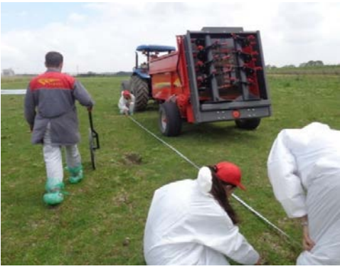
Şekil 2. Arazideki deney ortamının hazırlanması ve branda yönteminin uygulanışı
