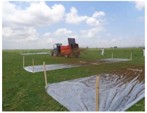
Şekil 2. Arazideki deney ortamının hazırlanması ve branda yönteminin uygulanışı
