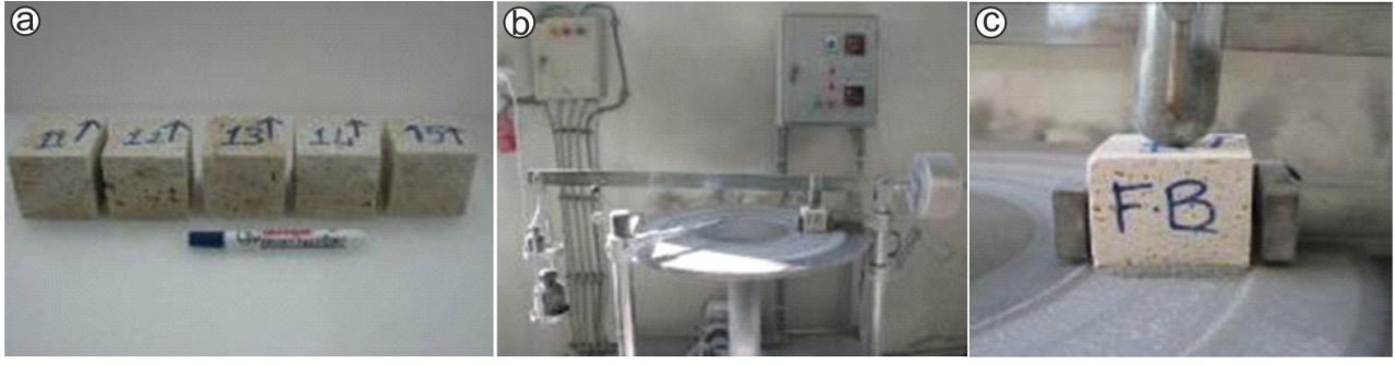
Şekil 7. Böhme yüzeysel aşınma deneyi a) Deney numuneleri b) Deney seti c) Deneyin yapılışı
