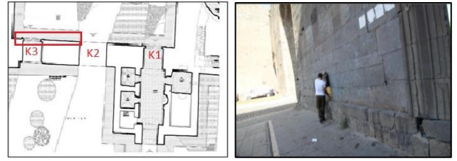
Şekil 18.Güney kapı (K3) ile orta kemerli kapı (K2) arasındaki sur duvarı (GPR-D1) tarama ve konumu
