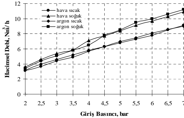
Şekil 6. Hava ve argon’un vorteks tüpünden çıkan soğuk ile sıcak akışkanın hacimsel debilerinin vorteks tüpüne girişteki basınca göre değişimi
