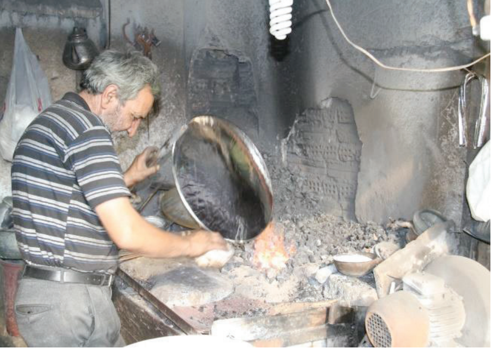
Foto. 8: Kalayı Yapılan Bakır Kabin Fazla Kalayının Sıyrılarak Alınması.
