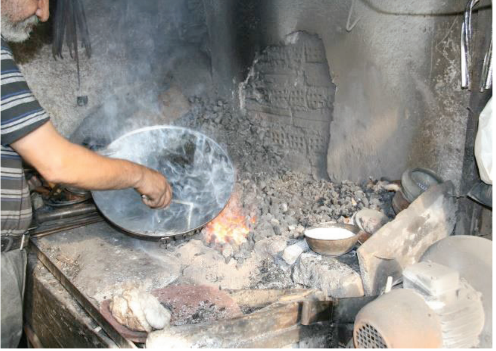
Foto. 6: Bakır Kaba Kalay Çubuğunun Sürülmesi.
