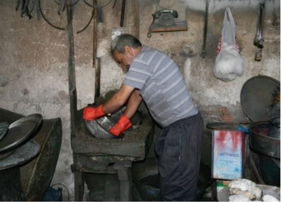
Foto. 3: Bakır kabın kumlama yöntemiyle temizlenmesi.
