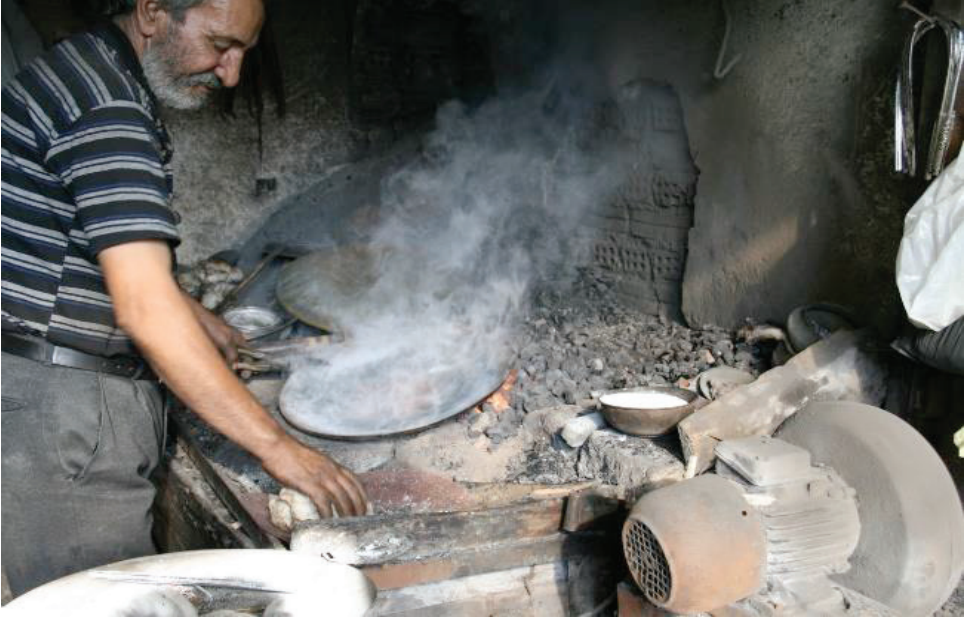
Foto. 5: Kalayı Yapılacak Bakır Kaba Nişadır Sürülmesi.
