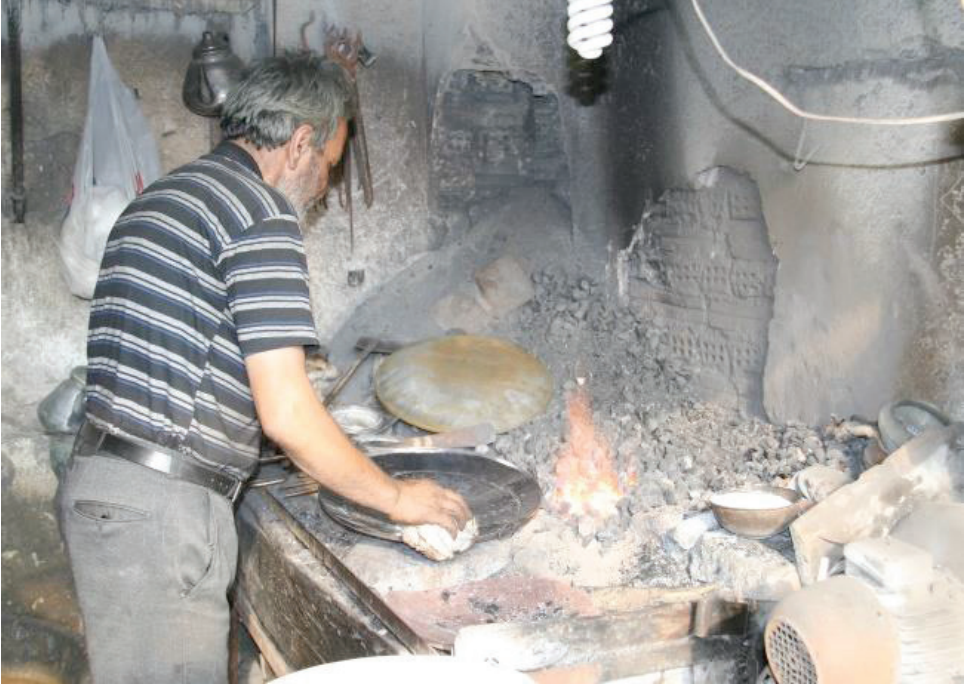
Foto. 4: Kalayı Yapılacak Olan Kabın Ocakta Isıtılması.
