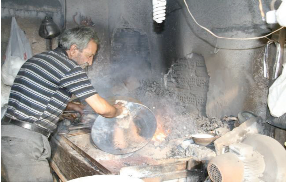
Foto. 7: Bakır Kaba Kalayın Pamukla Yedirilmesi.
