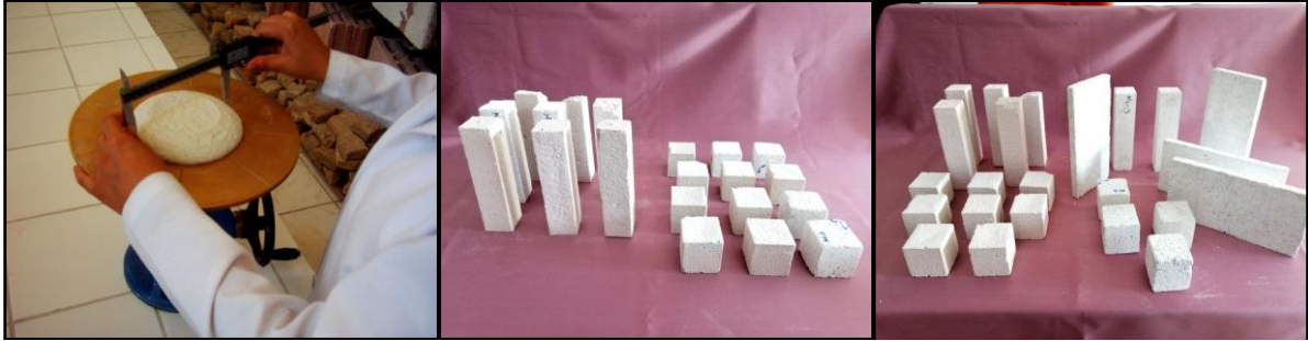
Şekil 2. Taze harcın akma tablasındaki yayılma durumu ve deneysel çalışmalarda kullanılan numunelerden genel bir görünüm
