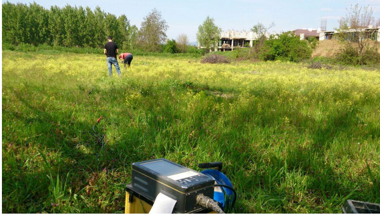
Şekil 5. MASW ölçümlerinden bir görünüm
