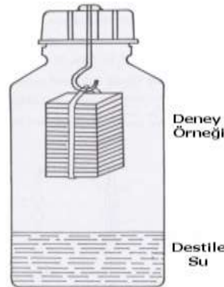
Şekil 1. Şişe metodu deney düzeneği (Test apparatus of flask method)
